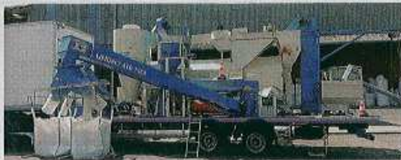
La nouvelle machine de traitement semence Coopaca entre dans le champ des appareils d'application de phytosanitaires, au même titre qu'un pulvérisateur
